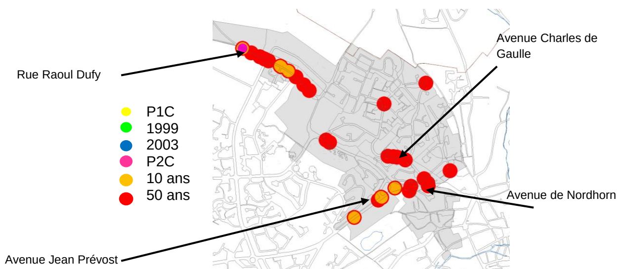
Figure 26 : Débordements sur le bassin versant Lombards
