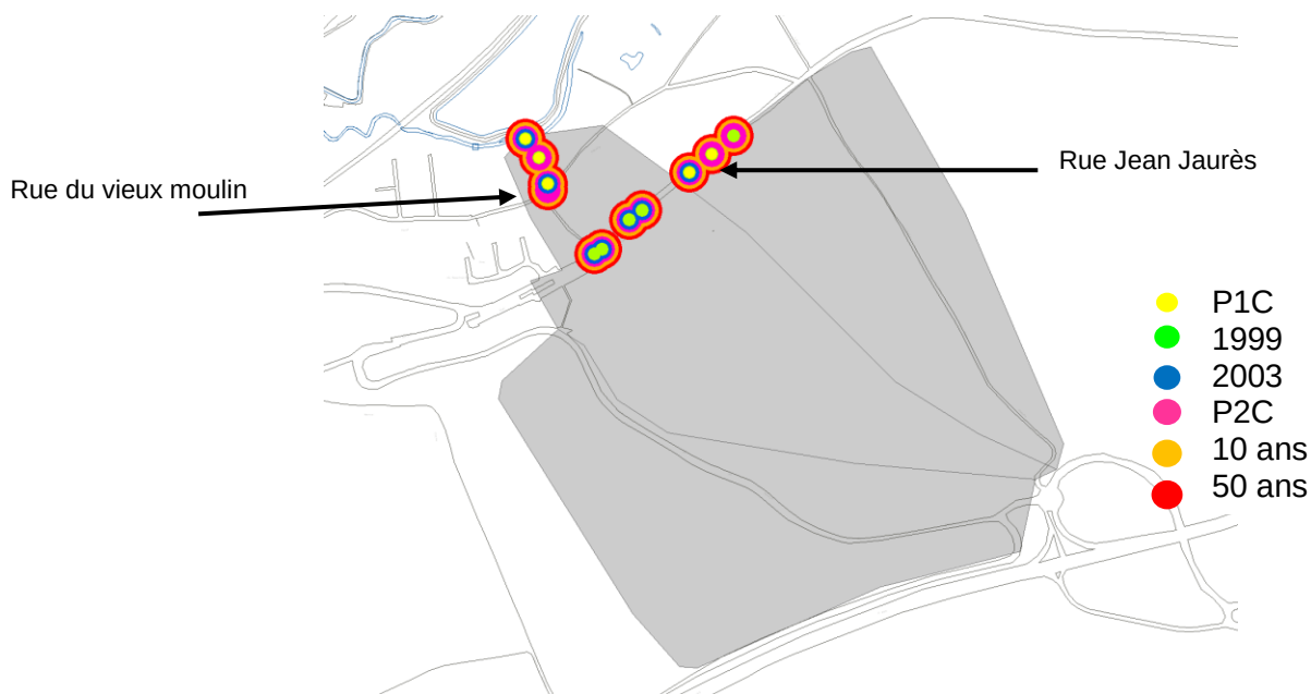
Figure 34 débordement sur le bassin versant Vieux Moulin
